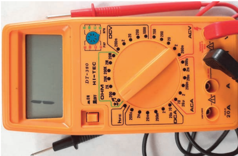
Rysunek 1.23. Po ustawieniu przełącznika w pozycję oznaczoną nutą przyrząd będzie sygnalizował dźwiękiem wykrycie zwarcia
