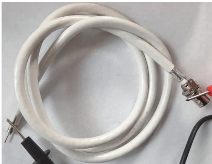
Rysunek 1.25. Pomiar pozwala sprawdzić, czy kabel nie ma przerwy, a złącze zostało prawidłowo podłączone
