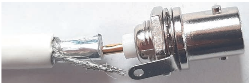
Rysunek 1.4. Jeden cienki drucik ekranu dotykający do żyły kabla może spowodować zwarcie
